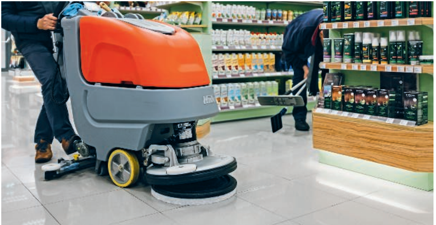
Bei einer mit Melaminpads ausgerüsteten Scheuersaugmaschine muss die zu reinigende Bodenfläche aufgrund der mechanischen Reinigungsleistung in der Regel nur einmal abgefahren werden.
