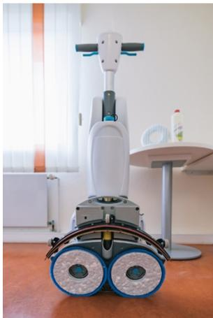
Wendig und leicht: der i-mop ist bei vielen Reinigungskräften beliebt. Noch besser reinigt der Nassschrubbautomat, den es in den Varianten XL (Bild), XXL und lite gibt, elastische und mineralische Bodenbeläge, wenn die Bürsten gegen Pads von haid-tec ausgetauscht werden.
