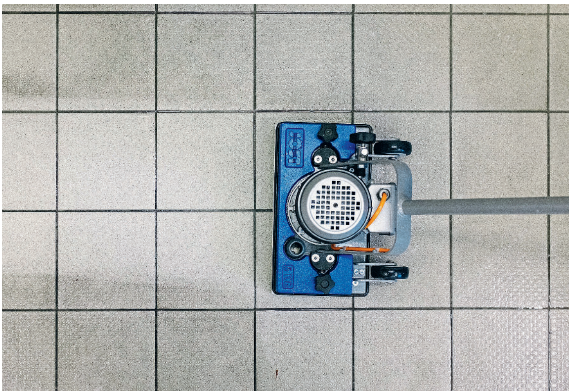
Mit einer handgeführten rechteckigen Exzentermaschine in Kombination mit Pads und dem richtigen Feinsteinzeugreiniger werden vergraute Sicherheitsfliesen wieder sauber.
